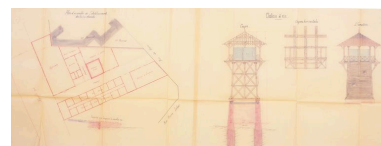
Mers-les-Bains. Projet d'établissement de bains chauds, plan de masse et détails du château d'eau 1890 (AD Somme ; 99 O 2594). Repro. Monnehay-Vulliet Marie-Laure IVR22_20038001168XAB
