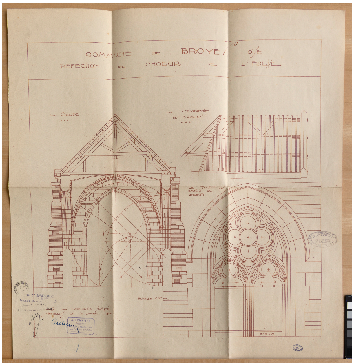
Broyes (Oise). Coupes pour la restauration du chœur de l'église, 1924 (AD Oise).
