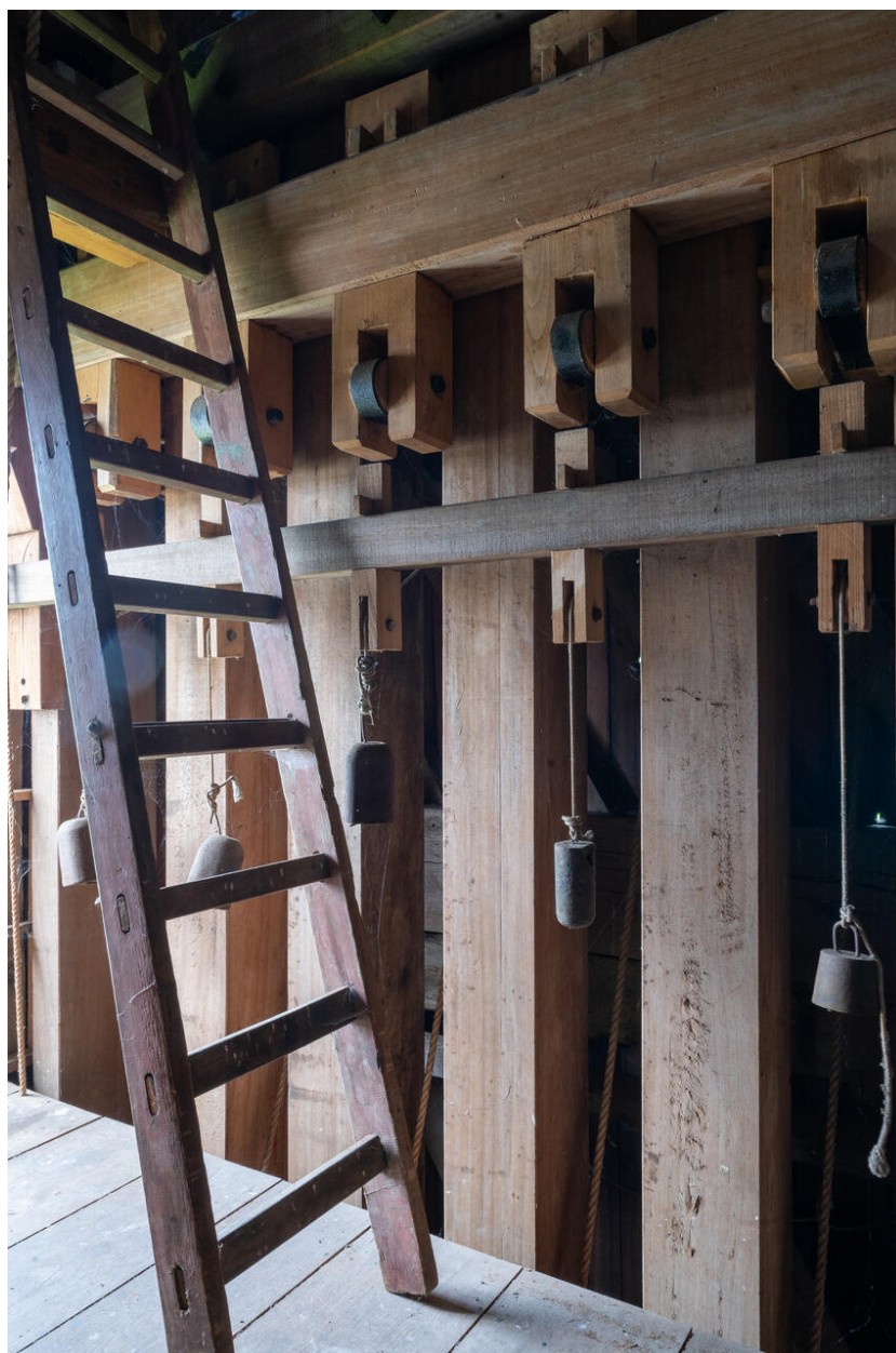
Second niveau du moulin. Vue de détail des pilons qui servent au broyage avec leurs contre-poids (ces derniers servent à tendre le levier).
