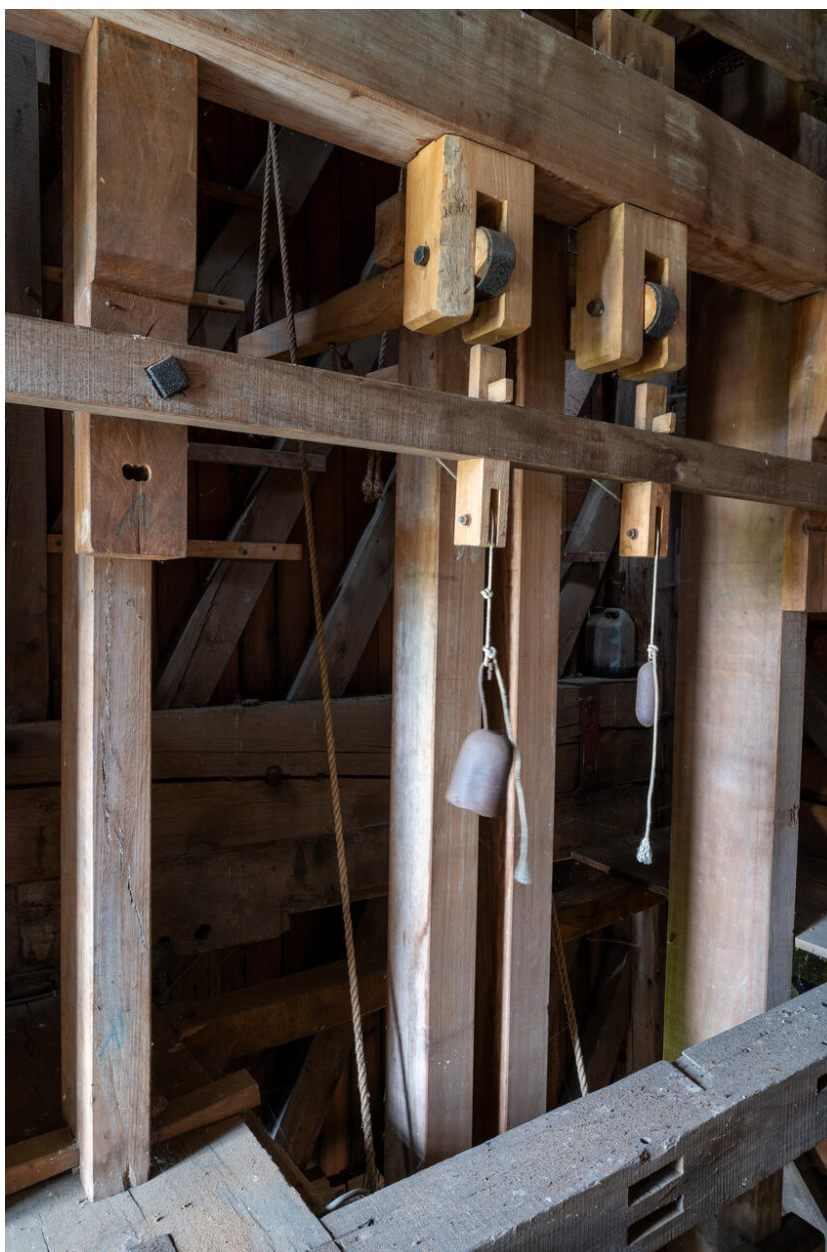
Second niveau du moulin. Vue de détail des pilons.
