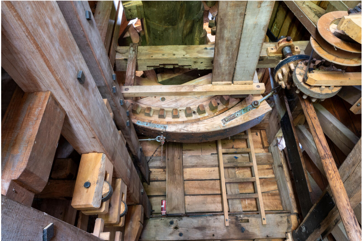
Vue de détail d'une partie du rouet, du levier du frein et des engrenages du mélangeur. La petite échelle attachée à la charpente permet de monter pour aller graisser le gros marbre.
