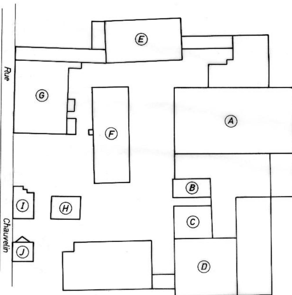
Schéma de situation : A. Ateliers de fabrication, B. Ancienne salle des machines, C. Chaufferie, D. Atelier de fabrication, E.F.G. MAgasins industriels, H. Bureaux, I. Logement patronal, J. Conciergerie.
