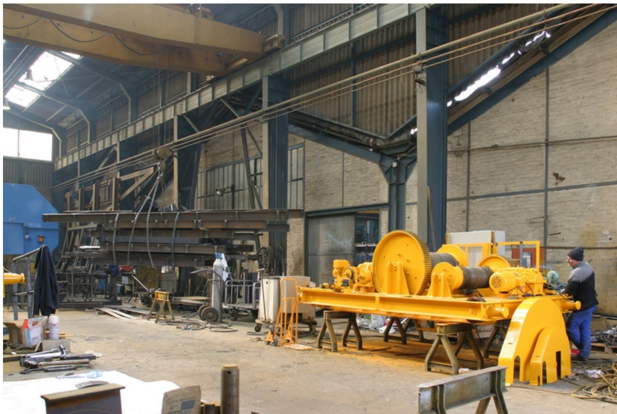
Atelier : assemblage d'un treuil.
