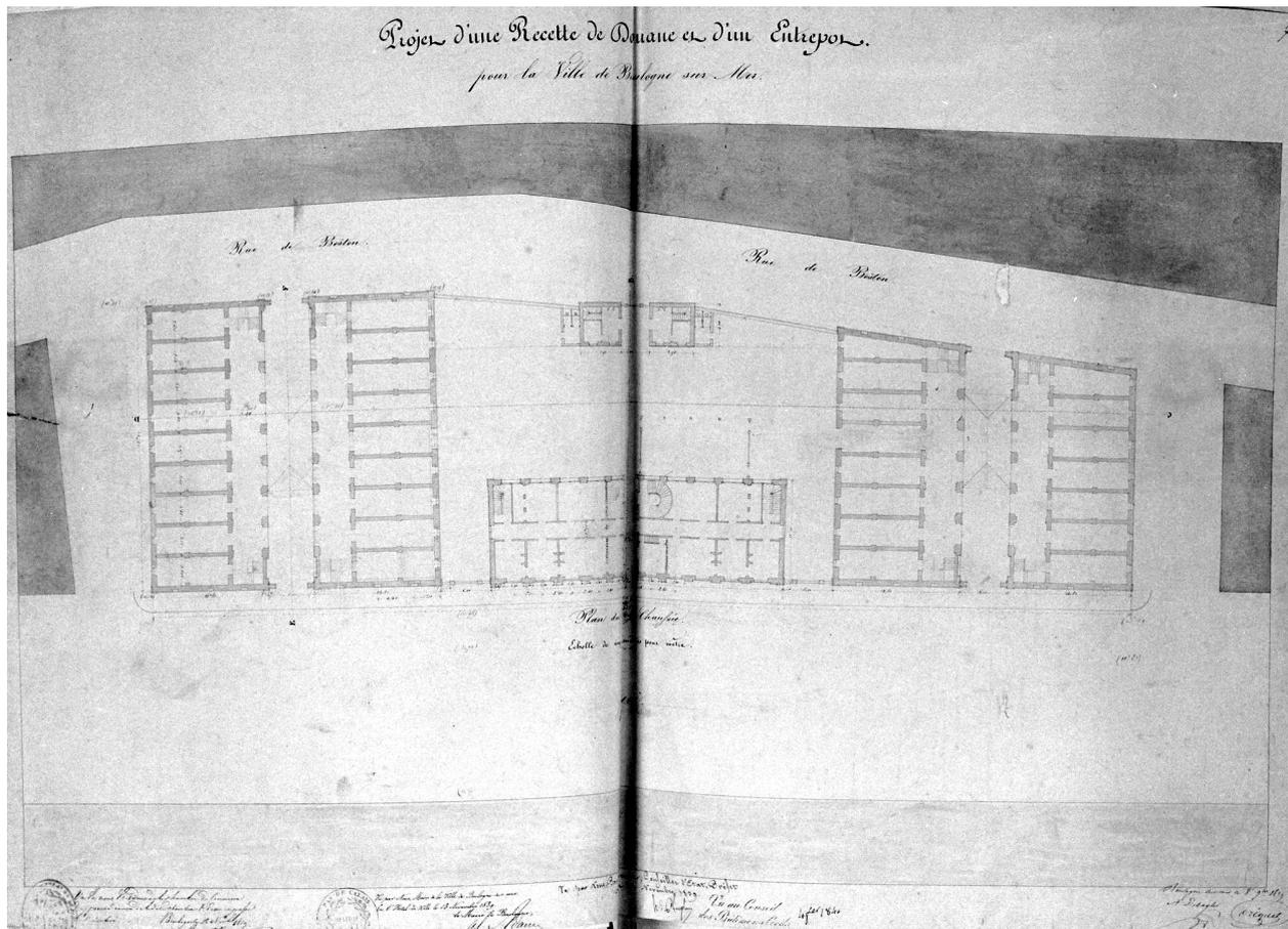
Douane, entrepôt public, plan du rez-de-chaussée, éch. 0,01 p.m. B.M. Boulogne-sur-Mer, ms 535 P. pl. 7.
