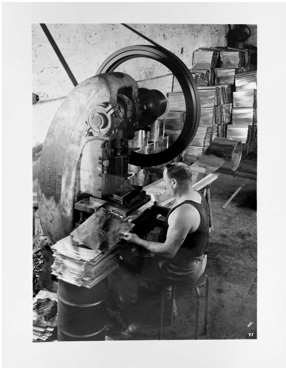
Atelier Tuilafer : la presse à volant type. Photographie ancienne, auteur inconnu, sans date (coll. part.).
