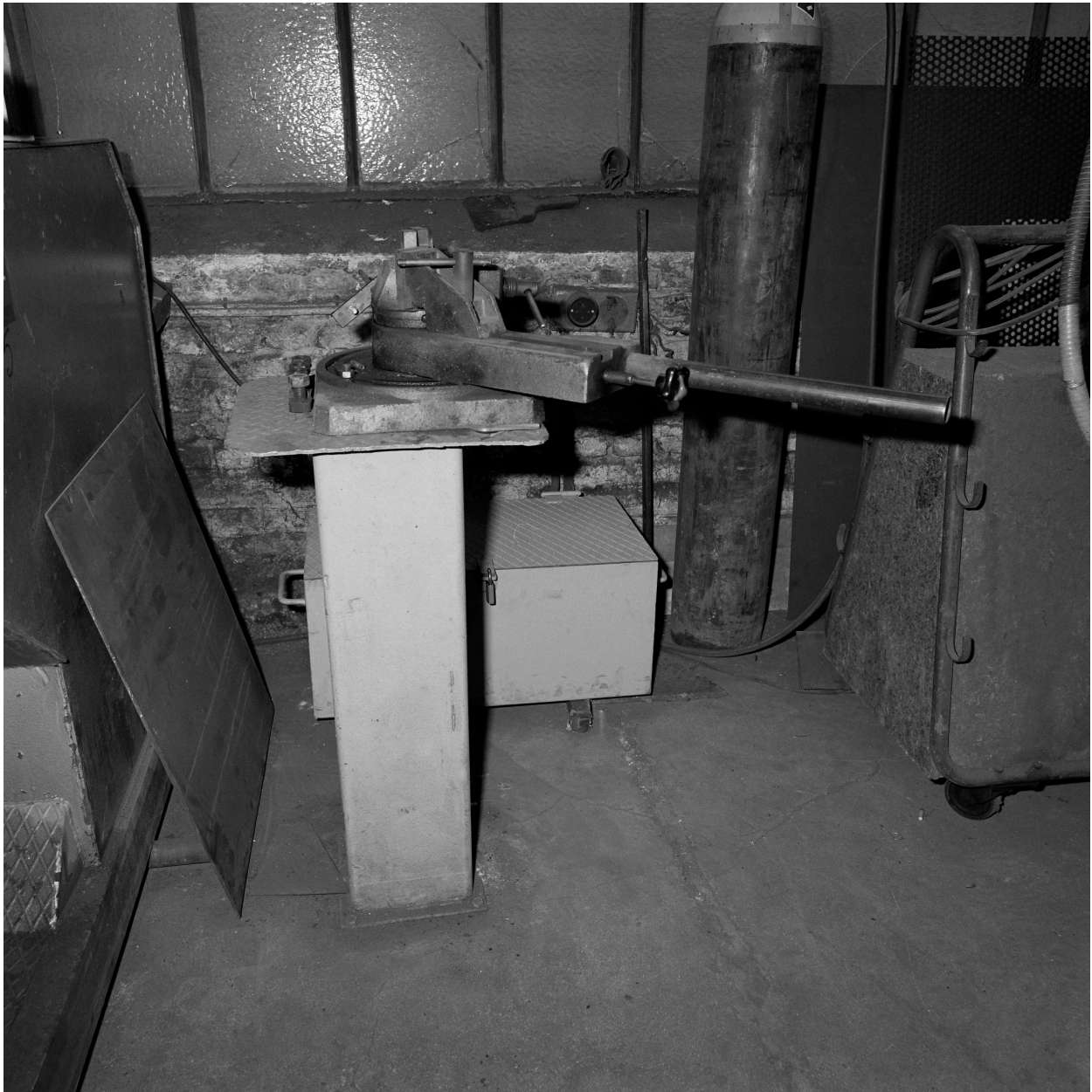
Atelier de fabrication, cintreuse à tube (sans marque).
