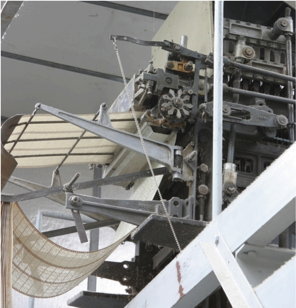
Vue de détail de la mécanique Jacquard.
