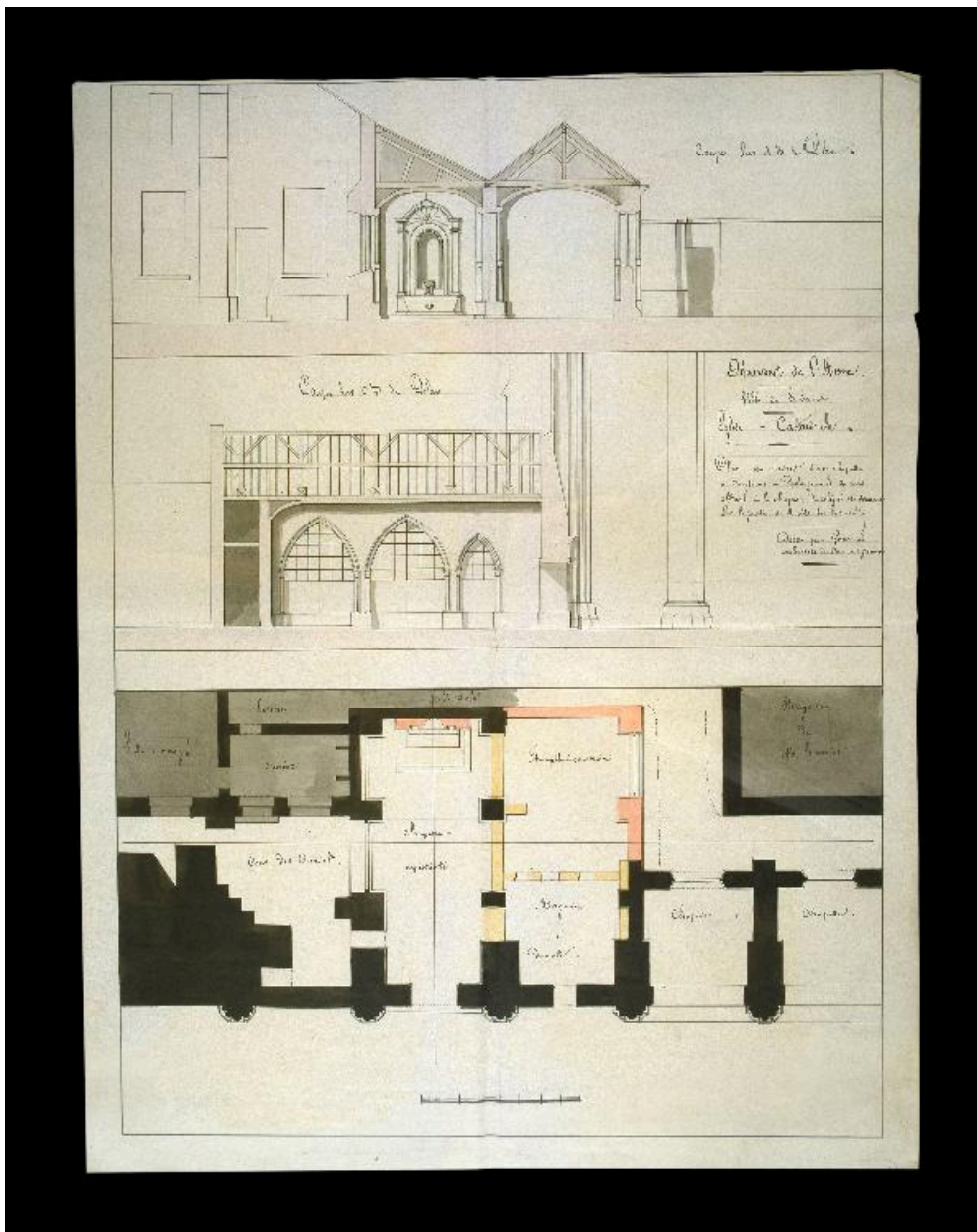
Plan et coupes d'une chapelle à construire à l'est de la chapelle du Collège, dessinés dans les années 1830 par l'architecte Antoine-Émile Gencourt (A. Évêché Soissons : P Soissons-Cathédrale, 3 D plans).
