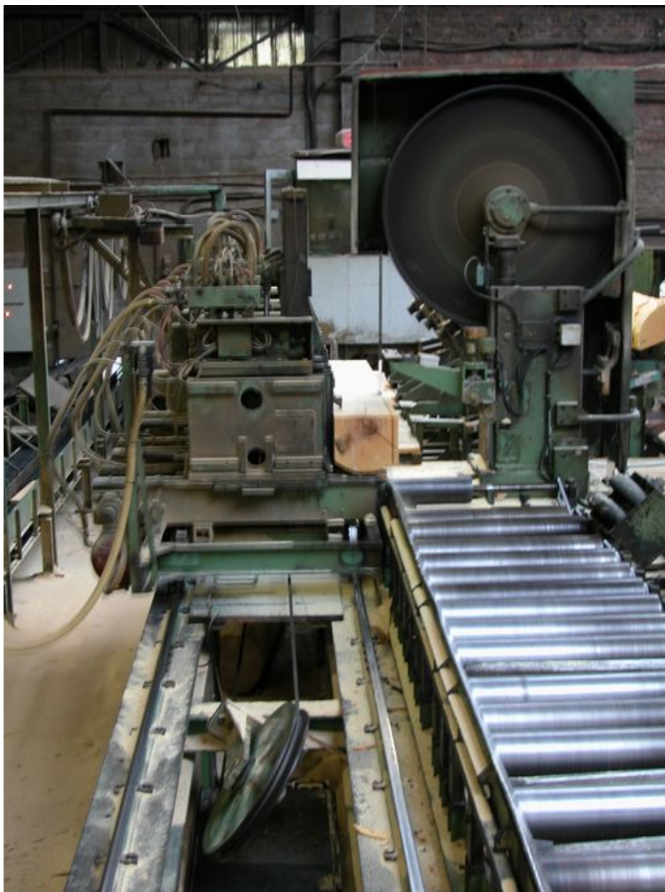
Découpe des grumes à la scie circulaire.
