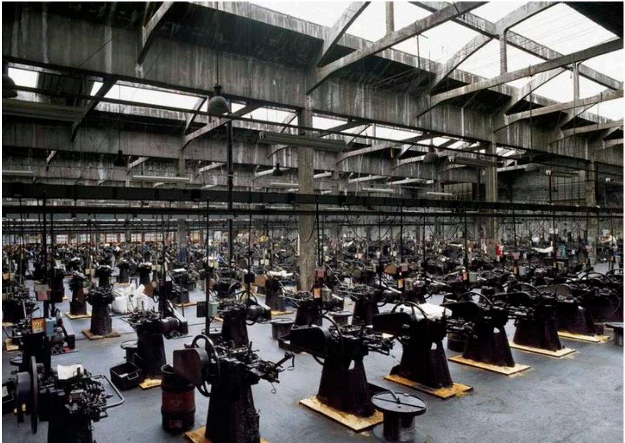
Machines à fabriquer les clous et détail de la structure en béton.
