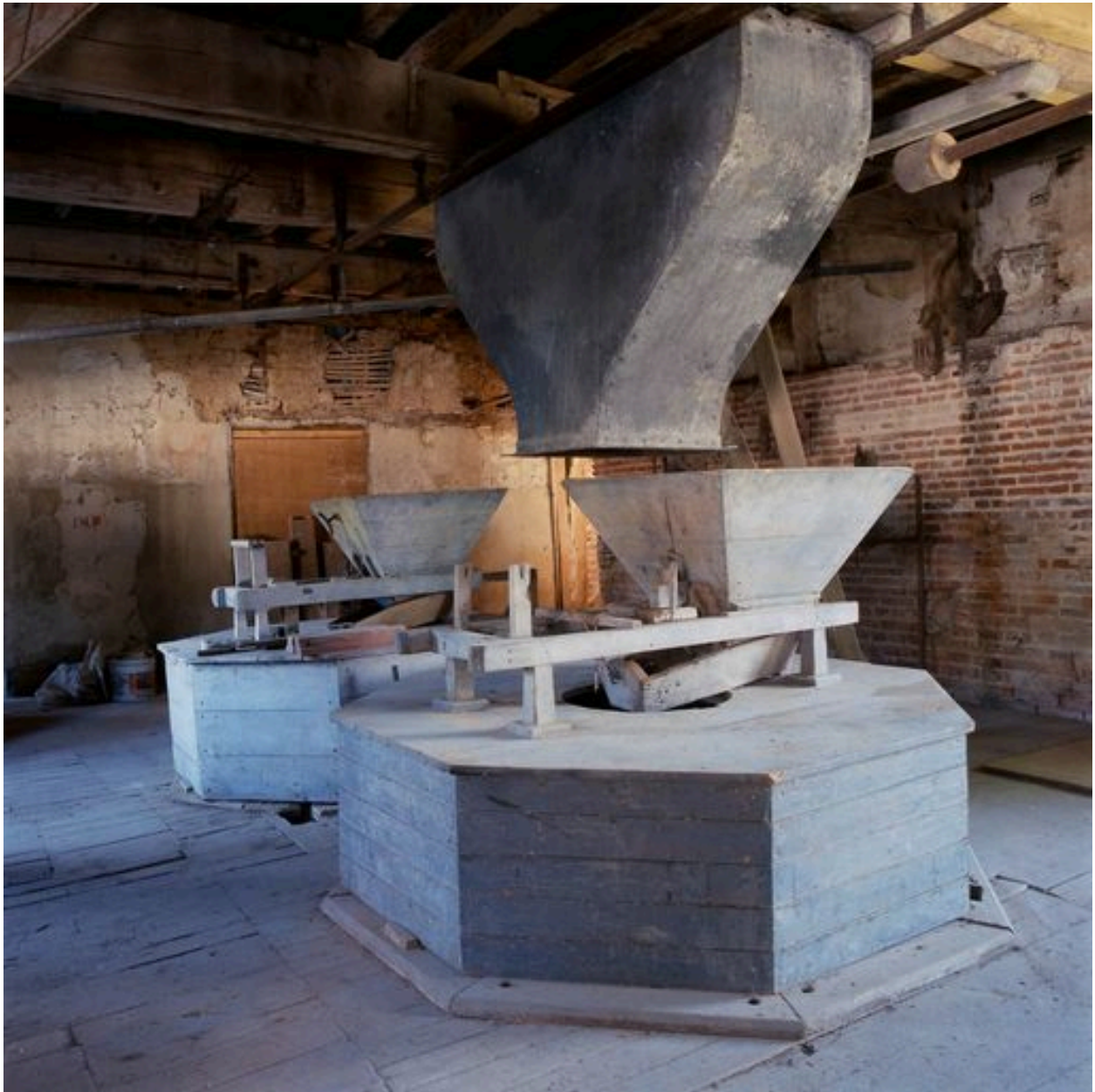
Intérieur du premier étage, vue des deux meules sous leur coffrage.
