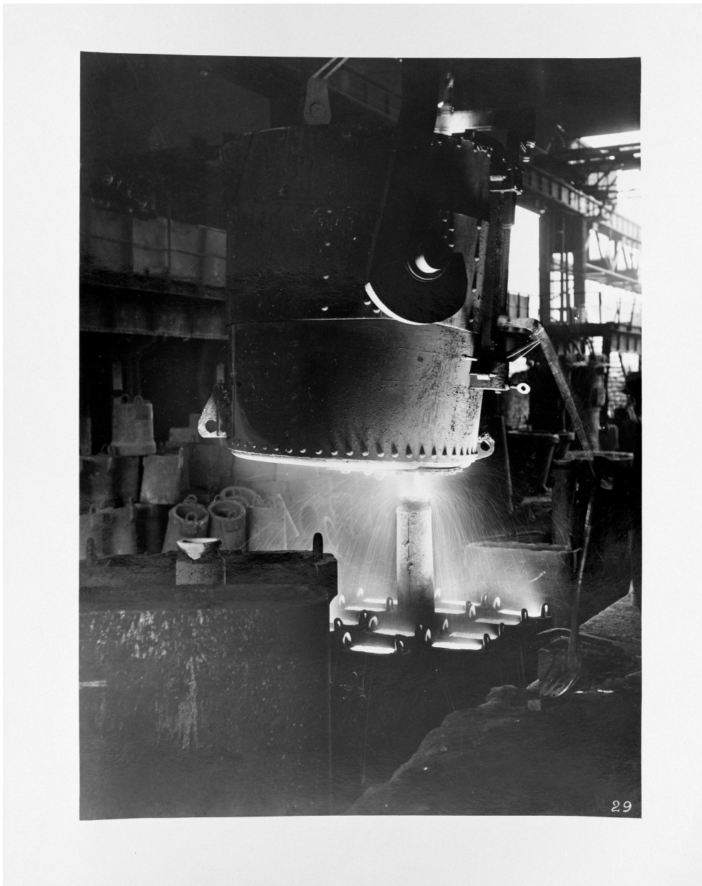
Bassin de coulée de l'aciérie : vue rapprochée de la coulée en lingotières, photographie, auteur inconnu, 1938 (coll. part.).
