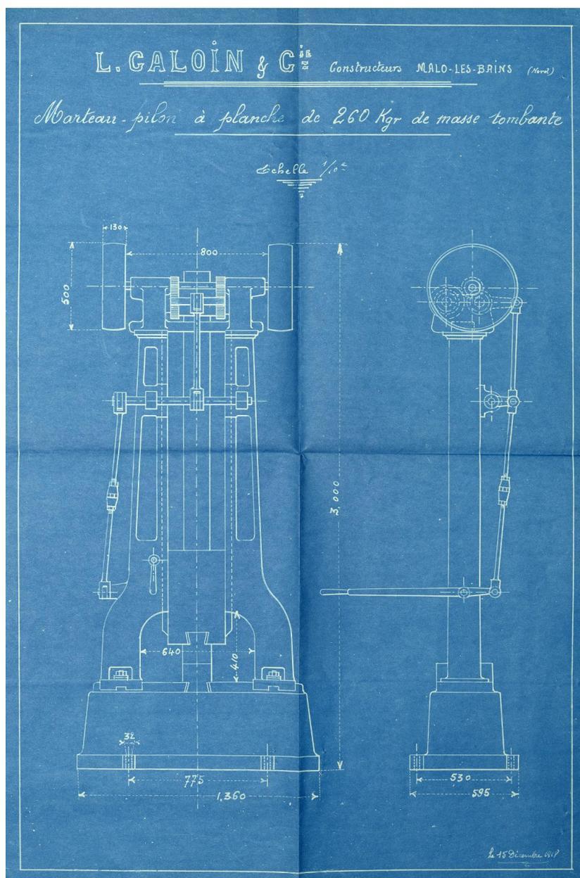
Vue de face et de profil du marteau-pilon installé au sein de l'atelier Caloin (AD Nord ; M41714668).
