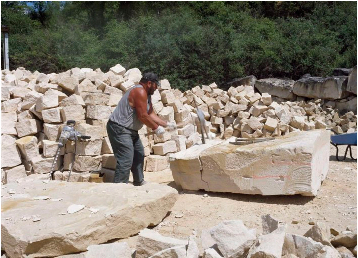
Débitage de blocs plus petits à la masse (carrière Ouachée-Corpechot, Saint-Maximin).
