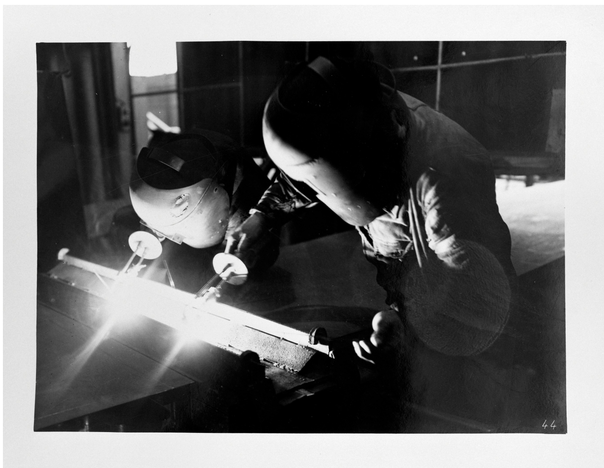
Atelier Rubafer, soudure de tôles. Photographie ancienne, auteur inconnu, sans date (coll. part.).
