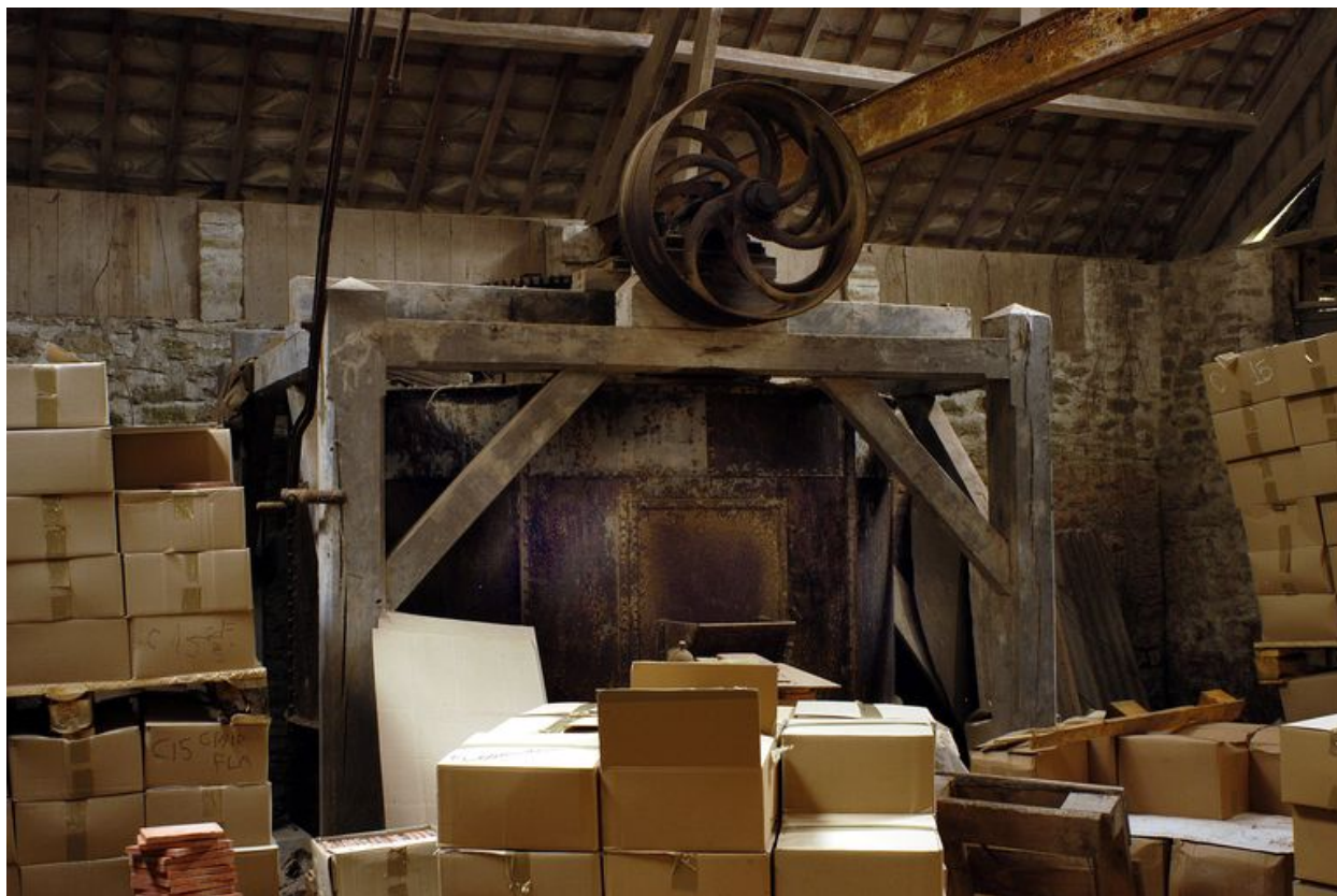
Broyeur à terre.
