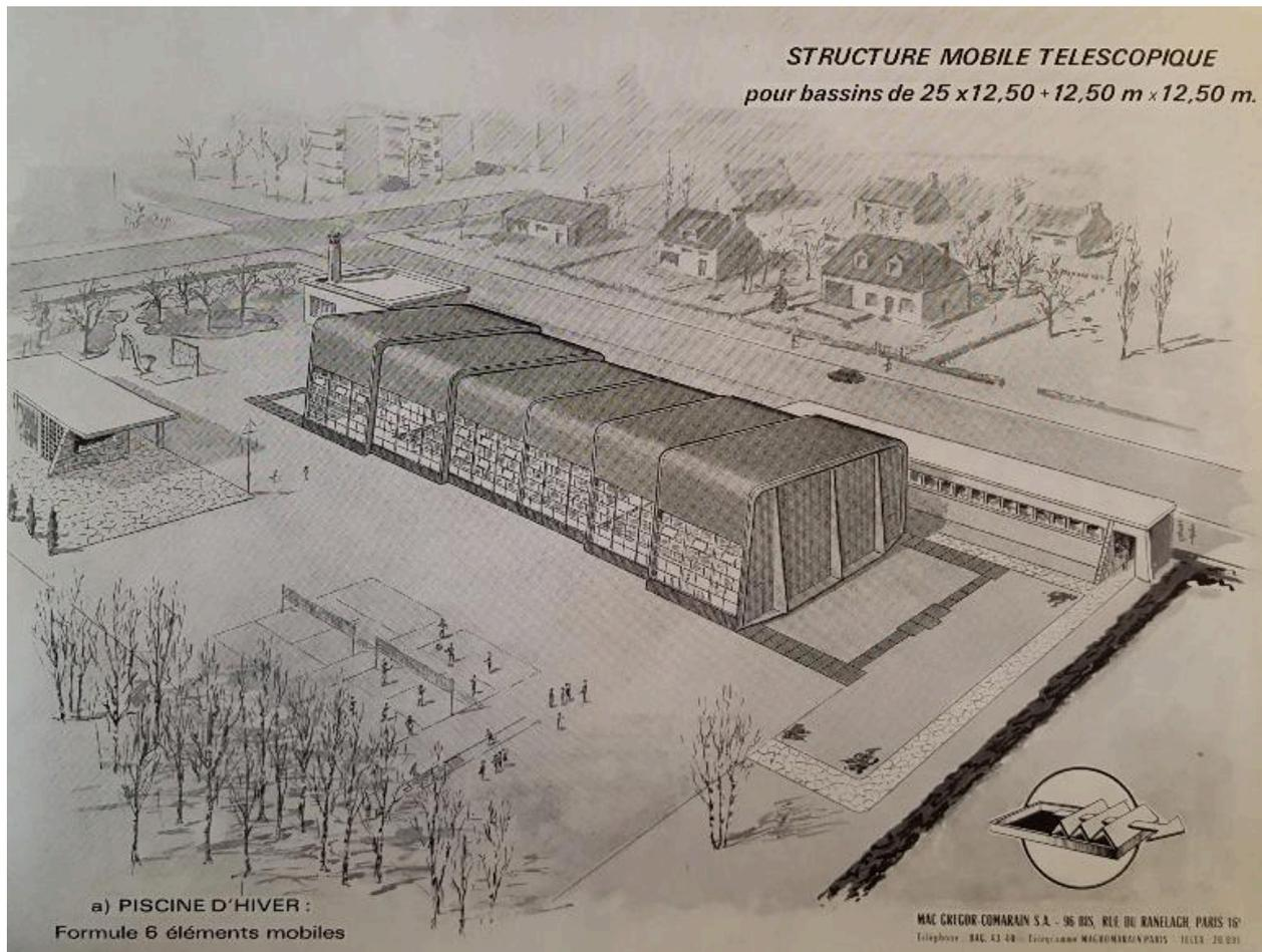
Dessin (perspective) montrant une possibilité d'adaptation de la structure mobile télescopique MacGregor-Comarain à une piscine d'hiver à deux bassin (AN ; 19940528/1).
