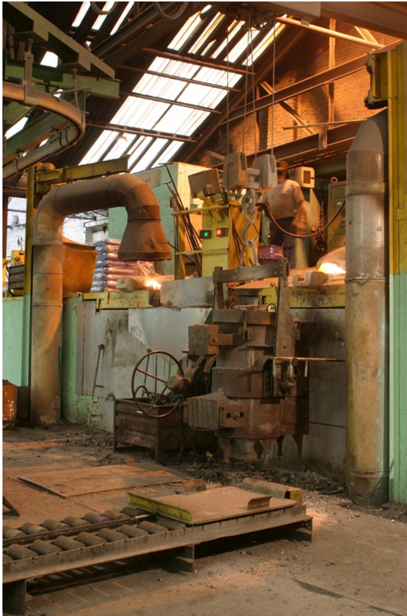
Poche de coulée prête à recevoir la fonte en fusion.
