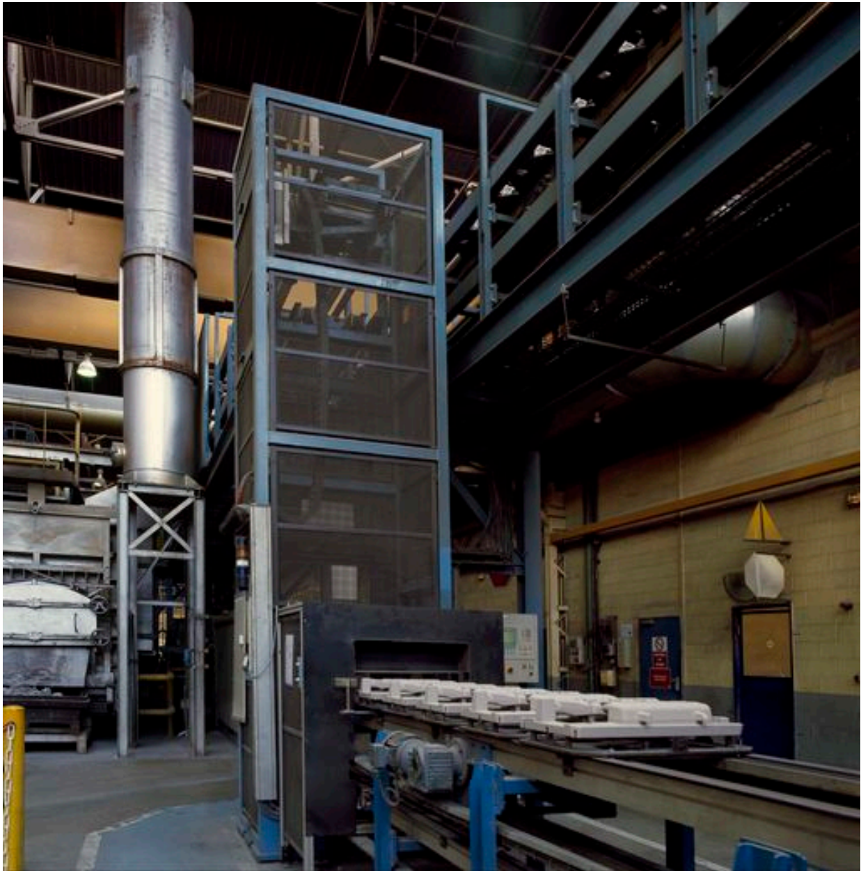
Départ des noyaux en silice et résine pour la fonte.
