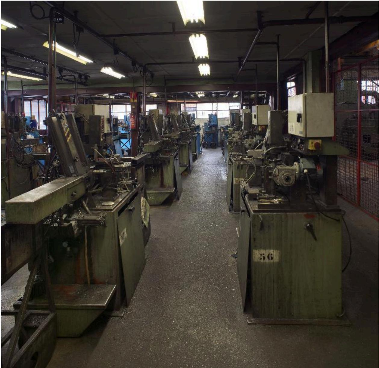
Atelier des couteaux, vue intérieure de la zone de défonçage et d'affutage.
