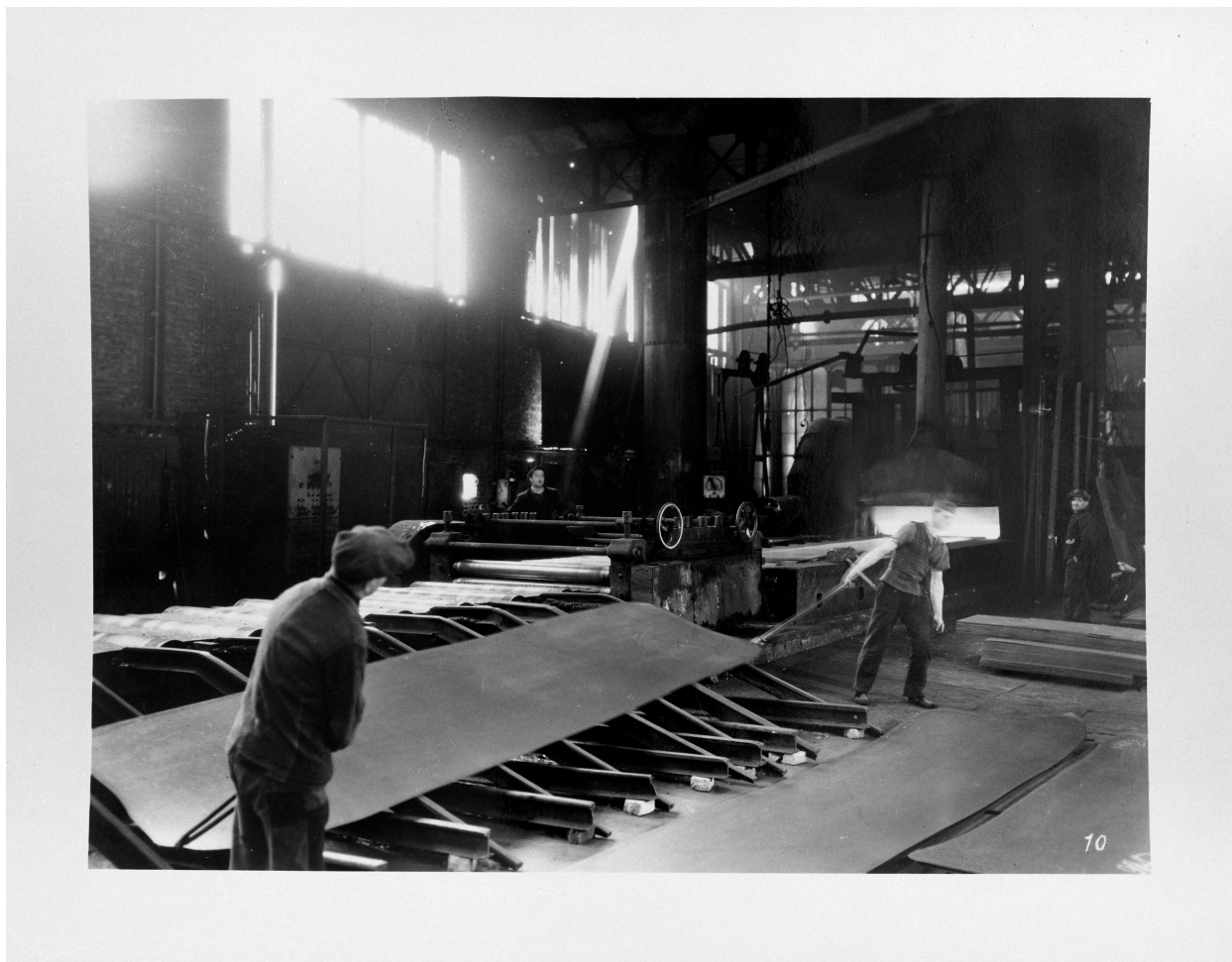
Découpage d'une tôle à sa sortie du laminoir. Photographie ancienne, auteur inconnu, sans date (coll. part.).
