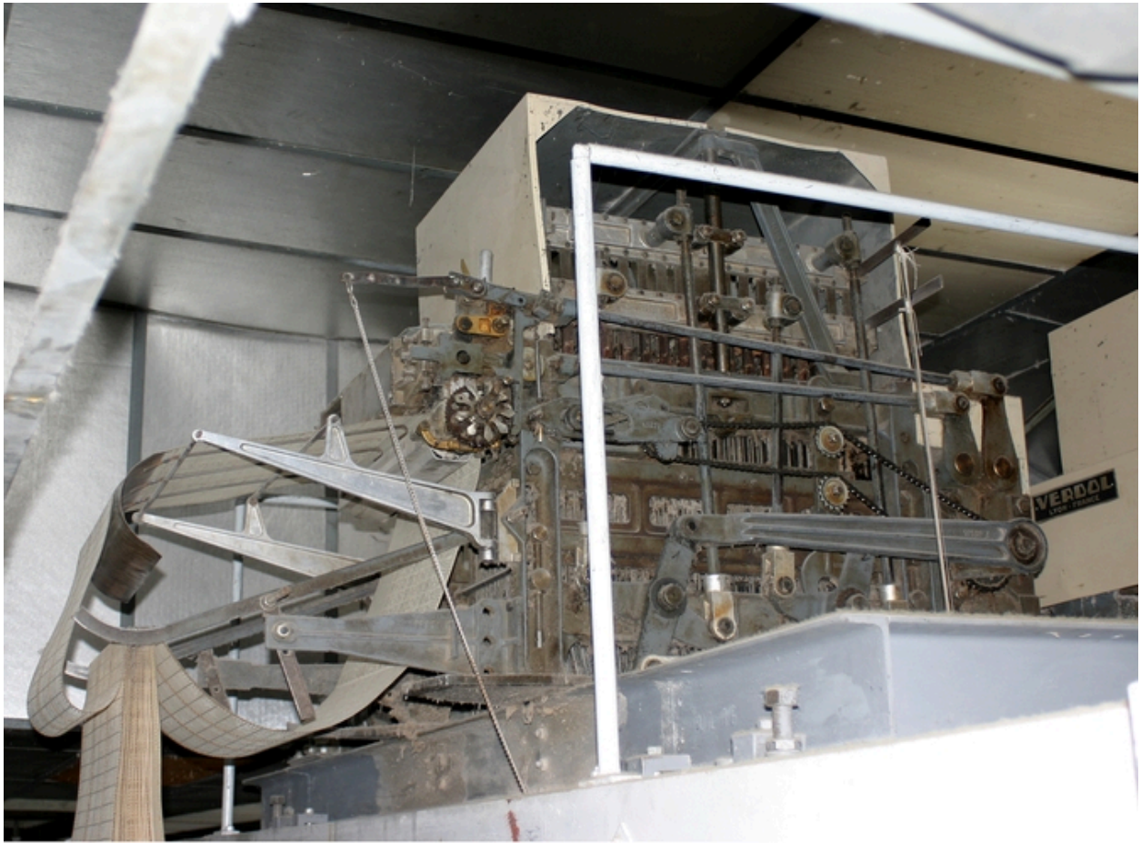
Mécanique Jacquard du constructeur lyonnais Verdol.
