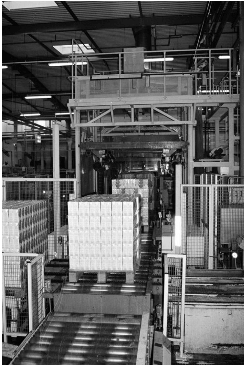
Atelier de conditionnement du lait, chaîne de mise en palettes des packs de lait.
