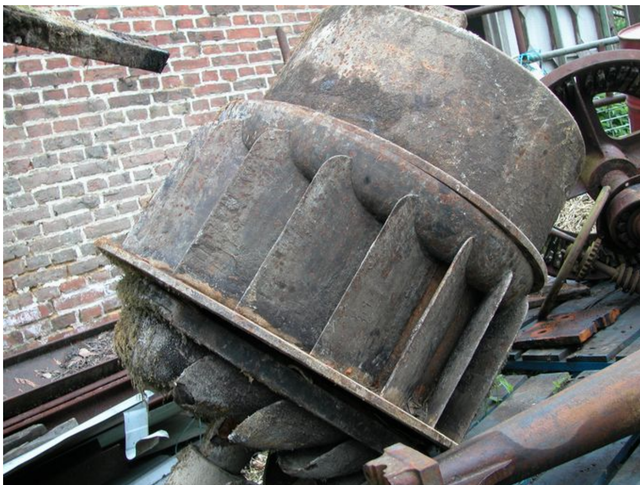
Vue d'ensemble de la turbine démontée.
