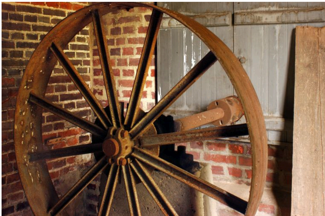
Détail de la poulie de transmission principale située dans l'atelier.
