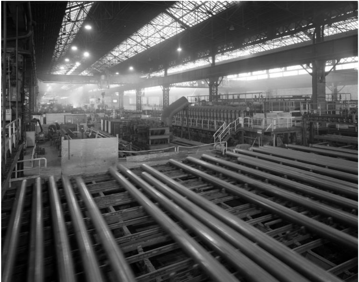
Les laminoirs (usine C) : le traitement thermique. Le four au milieu, à droite.
