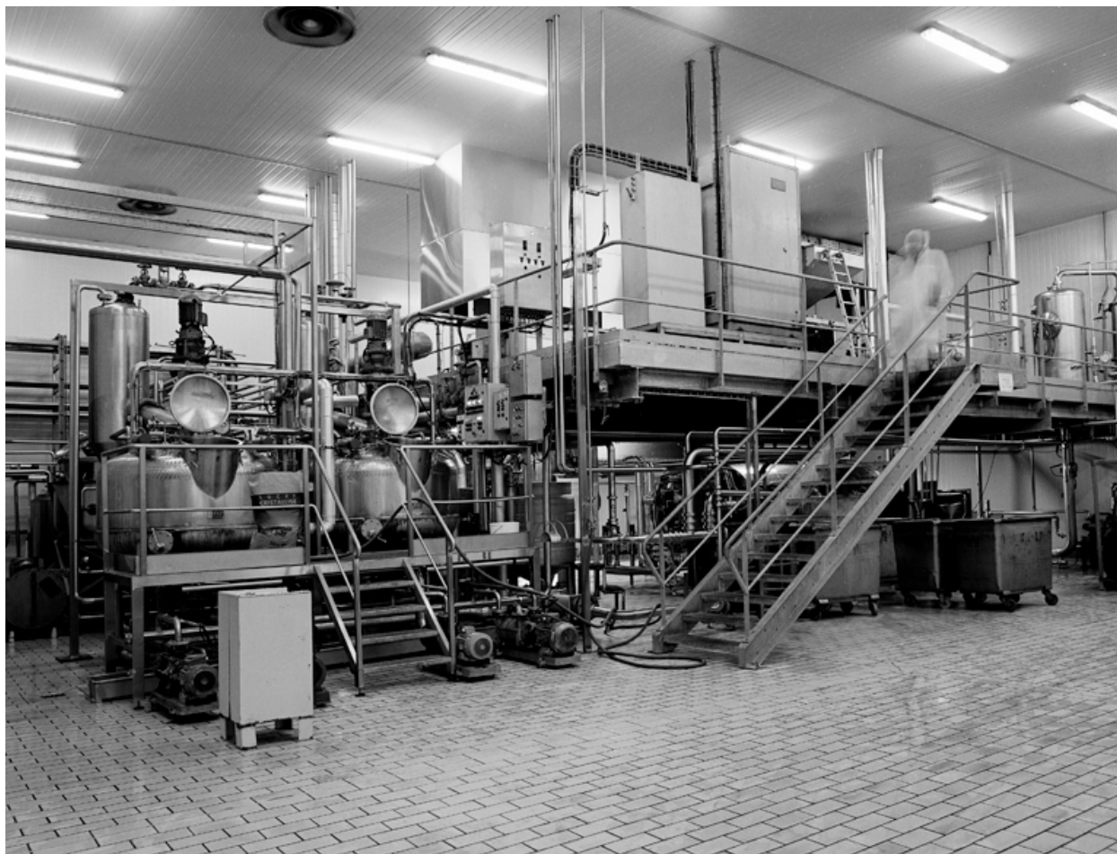
Vue de l'atelier de fabrication de la compote de pommes : machines diverses servant à cuire et mélanger les fruits puis à recueillir les déchets.
