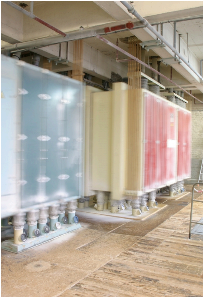
Quatrième étage de la minoterie : plansichters.
