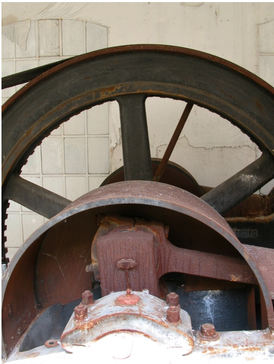
Axe du volant, arbre de transmission et bielle de l'un des deux moteurs.
