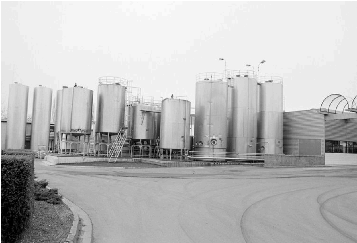
Réservoirs industriels pour le stockage du lait avant traitement de pasteurisation.
