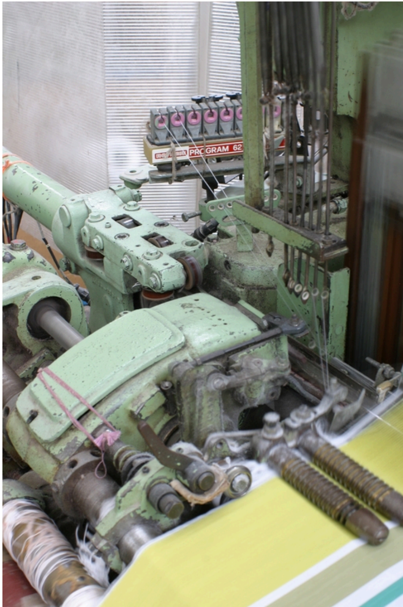
Vue générale des mécanismes de la lance d'entrée.
