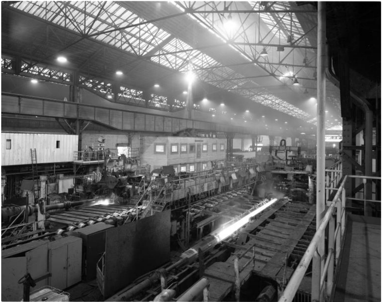
Salle des laminoirs (usine C). Vue générale de l'élongateur. Le tube vient d'être percé et va être étiré.
