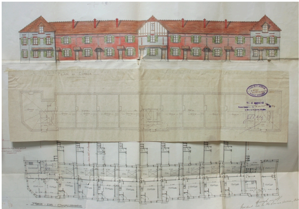
Façade antérieure et plans (rez-de-chaussée et combles) du groupe de 11 logements, par G. Dechard, vers 1924 (AC Saint-Quentin).
