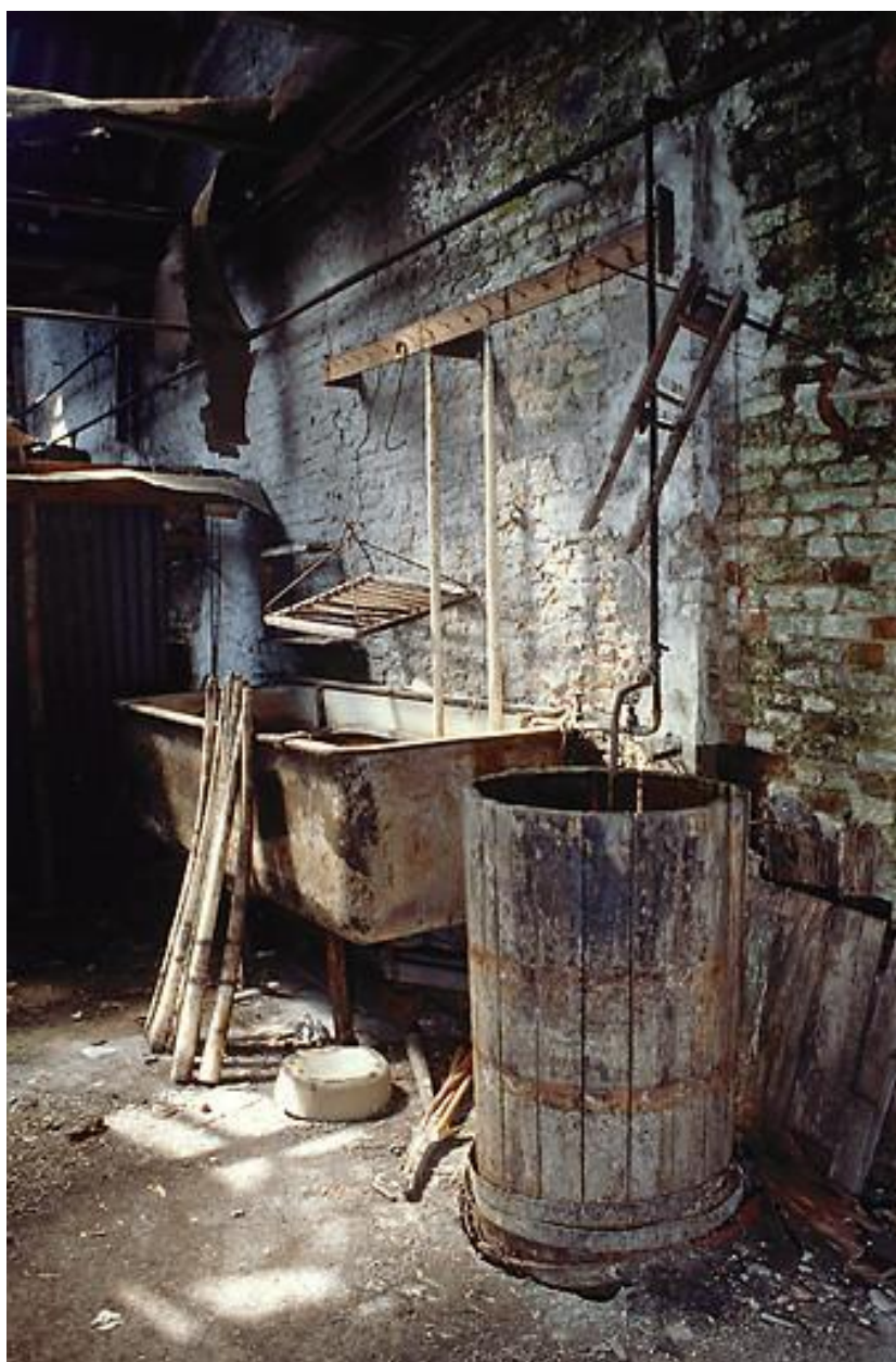
Atelier de fabrication. Vue des bacs de trempe pour ramollir les cierges.
