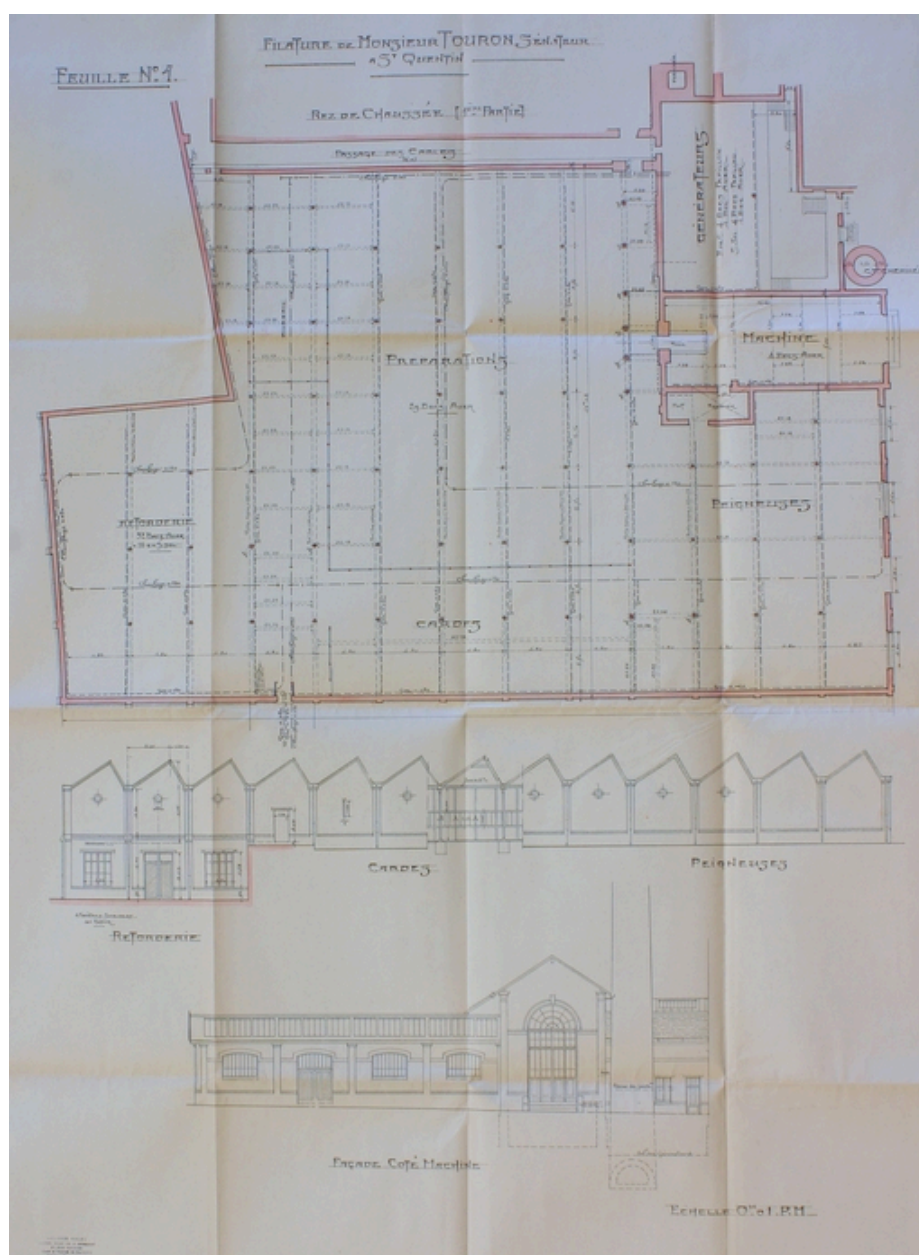
Plan des bâtiments de la filature construits en 1891, par Nalet : état en 1914 (AD Aisne).
