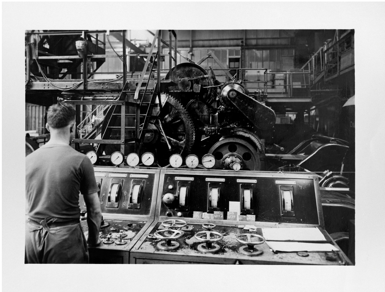
Atelier Rubafer, le laminoir : le pupitre de commande. Photographie ancienne, auteur inconnu, sans date (coll. part.).
