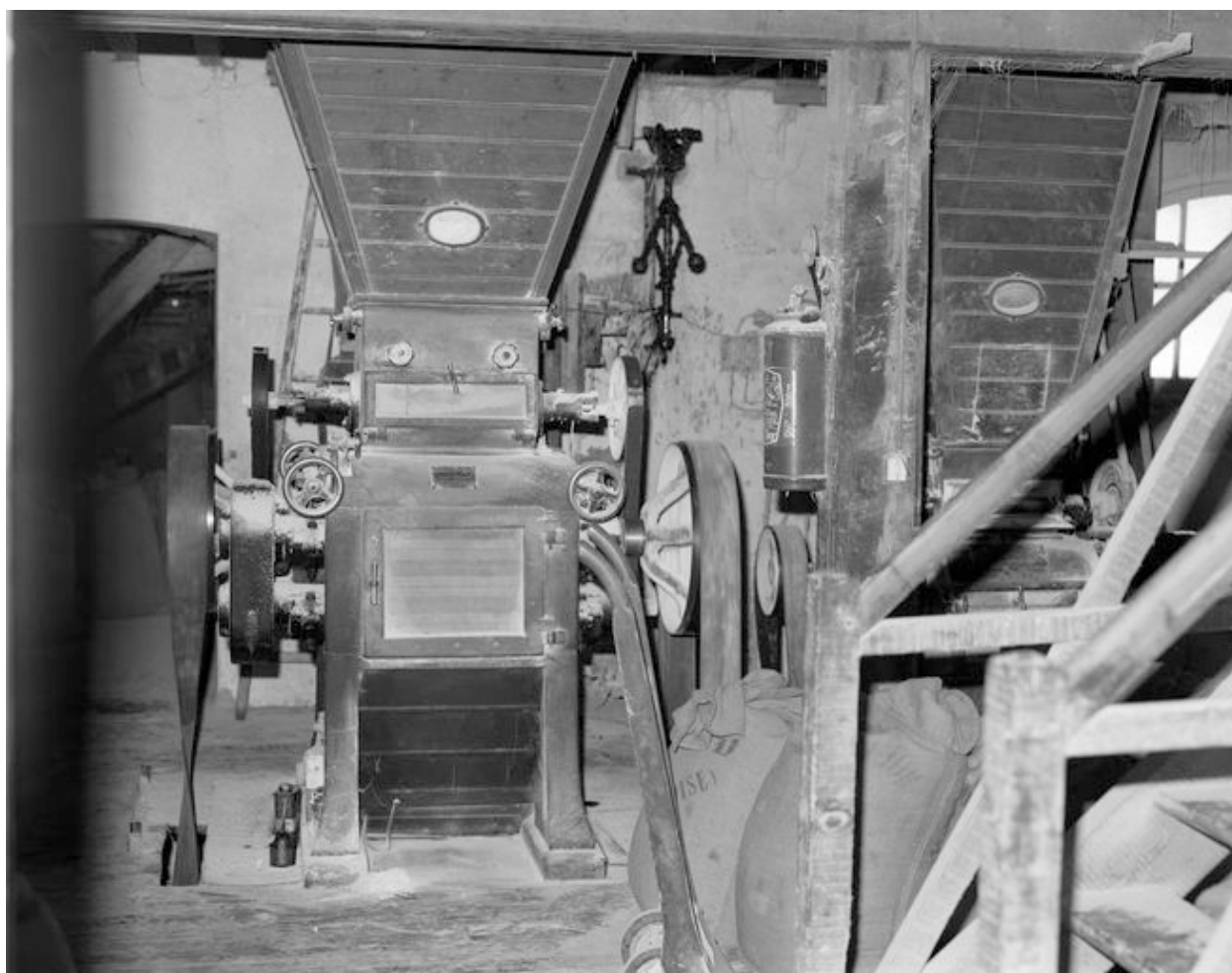
Vue intérieure du moulin, 1er étage : machine à broyer.
