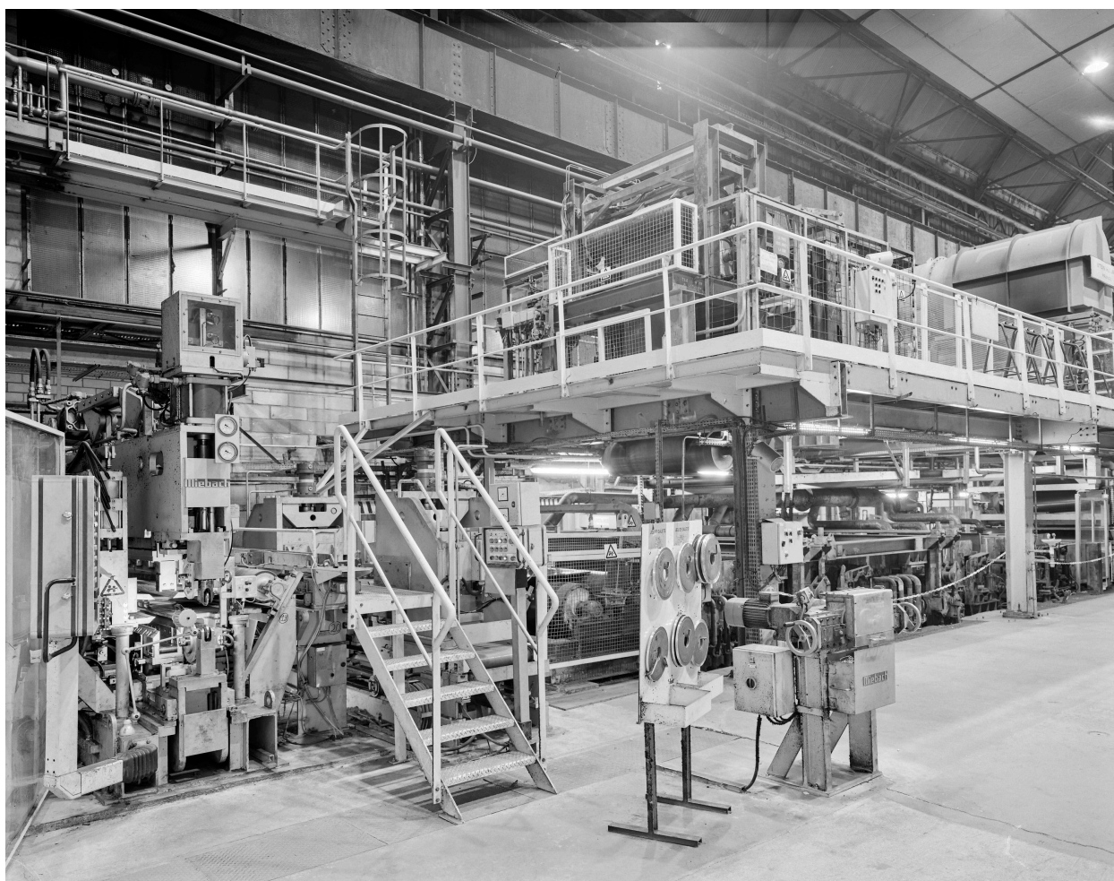
Soudage des rouleaux de tôles en vue de la galvanisation des tôles.
