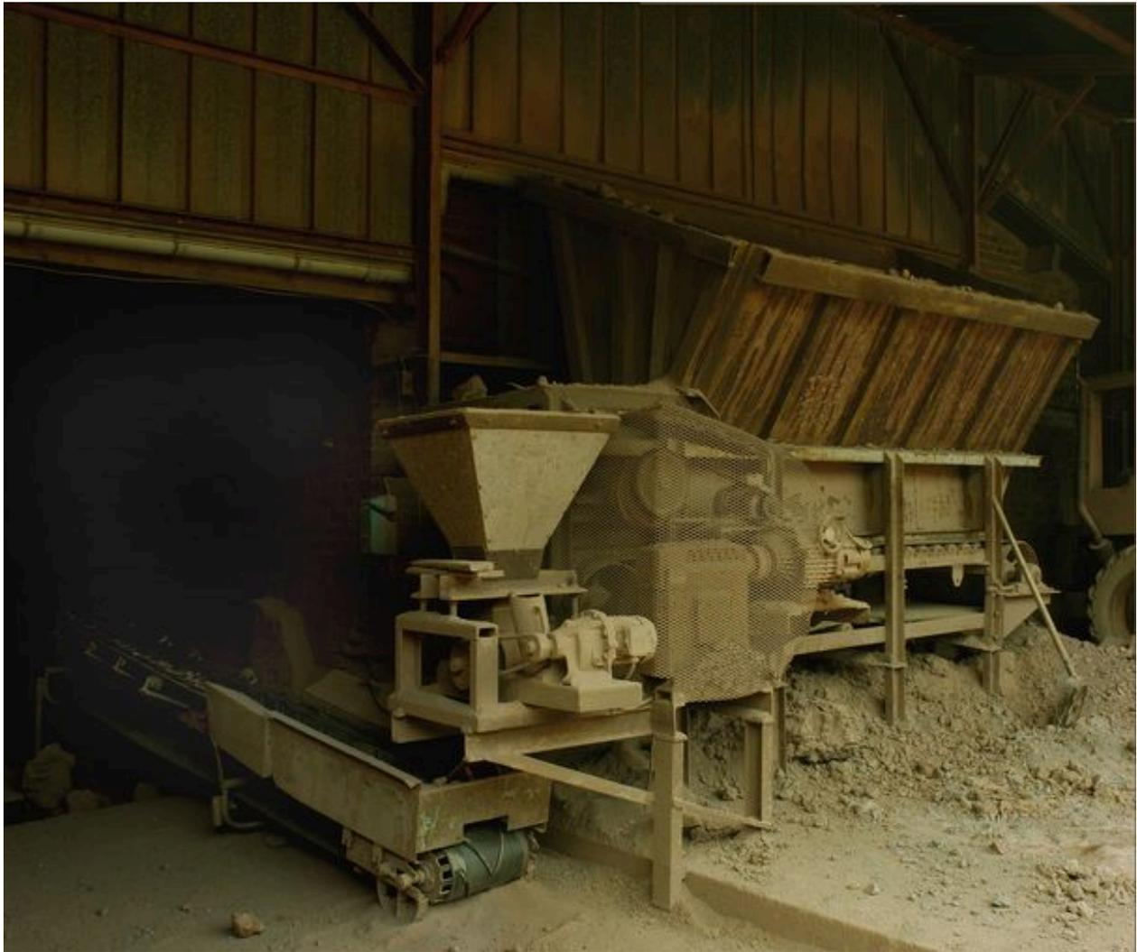
Machine à transporter les terres vers les broyeurs.
