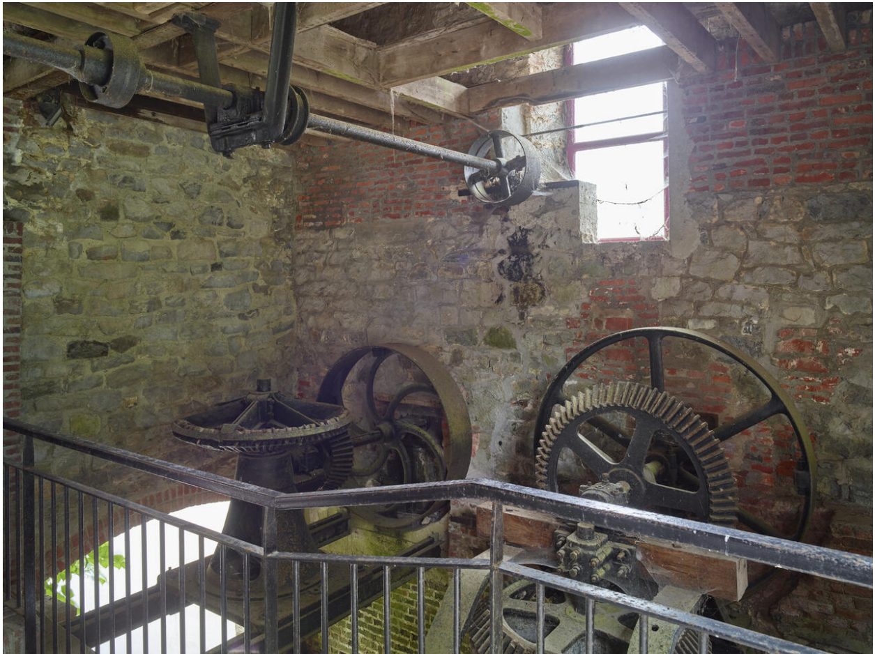
Le Petit moulin. Vue intérieure du système de transmission.
