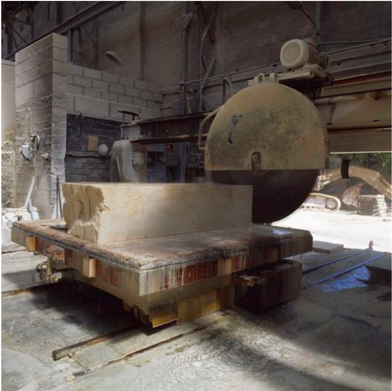
Découpage à la scie circulaire à diamants (carrière Ouachée-Corchepot, Saint-Maximin).
