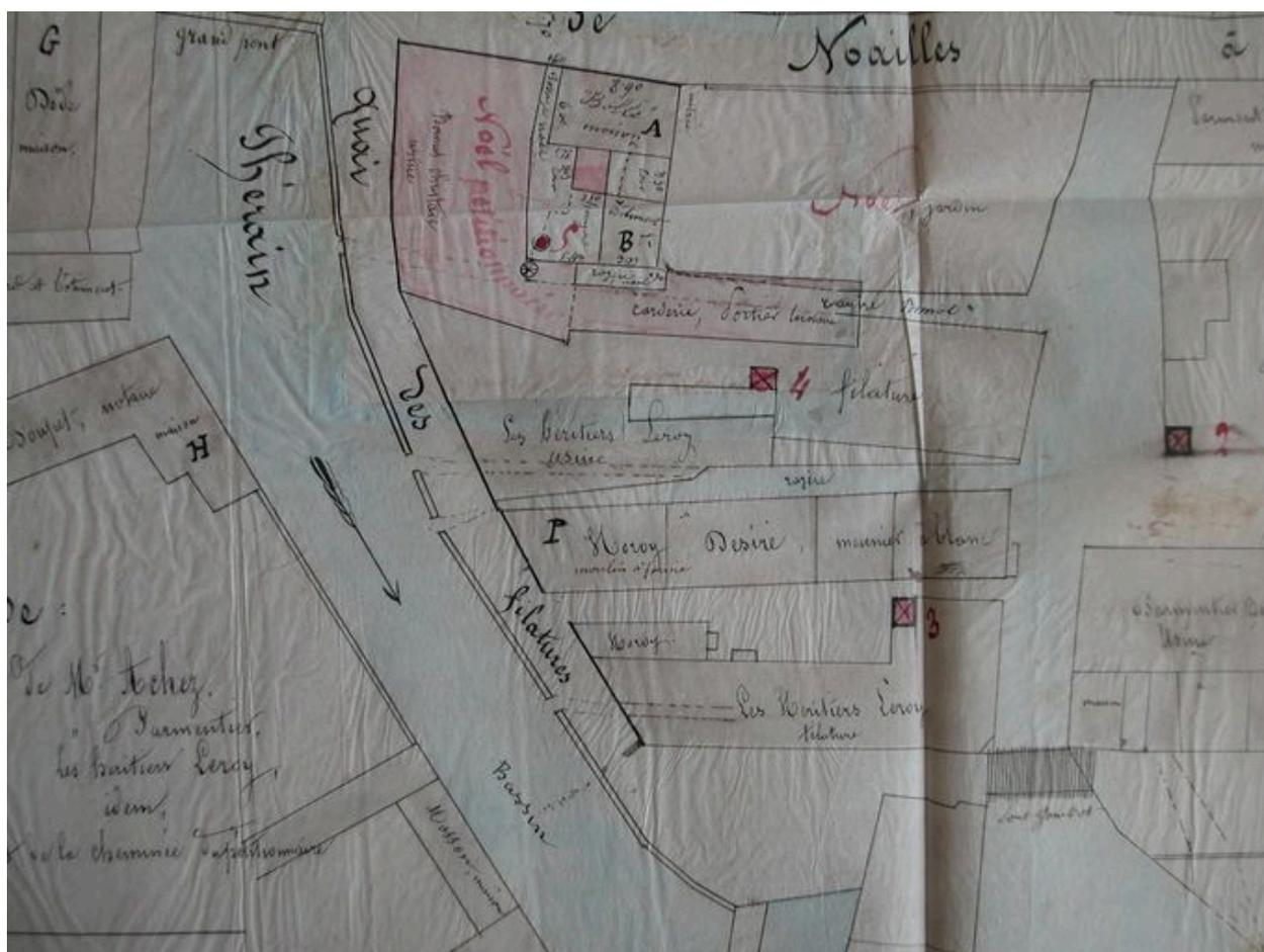
Plan des filatures sur le quai du Thérain, avec indication (en rouge) de l'emplacement des cheminées, Cruzet (géomètre), 1859.
