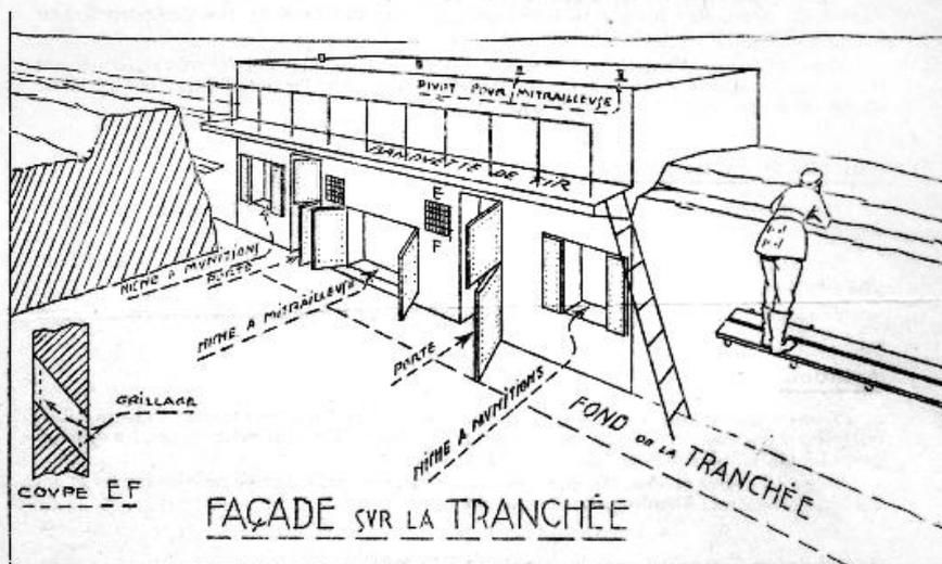
Lorsque la mitrailleuse n'est pas utilisée, elle est placée non pas à l'intérieur de l'abri, mais dans une grande niche ménagée dans la face postérieure de l'abri. D'autres niches, plus petites, contiennent les munitions. Ce dispositif permet de mettre la mitrailleuse à son emplacement de tir dans le minimum de temps.
