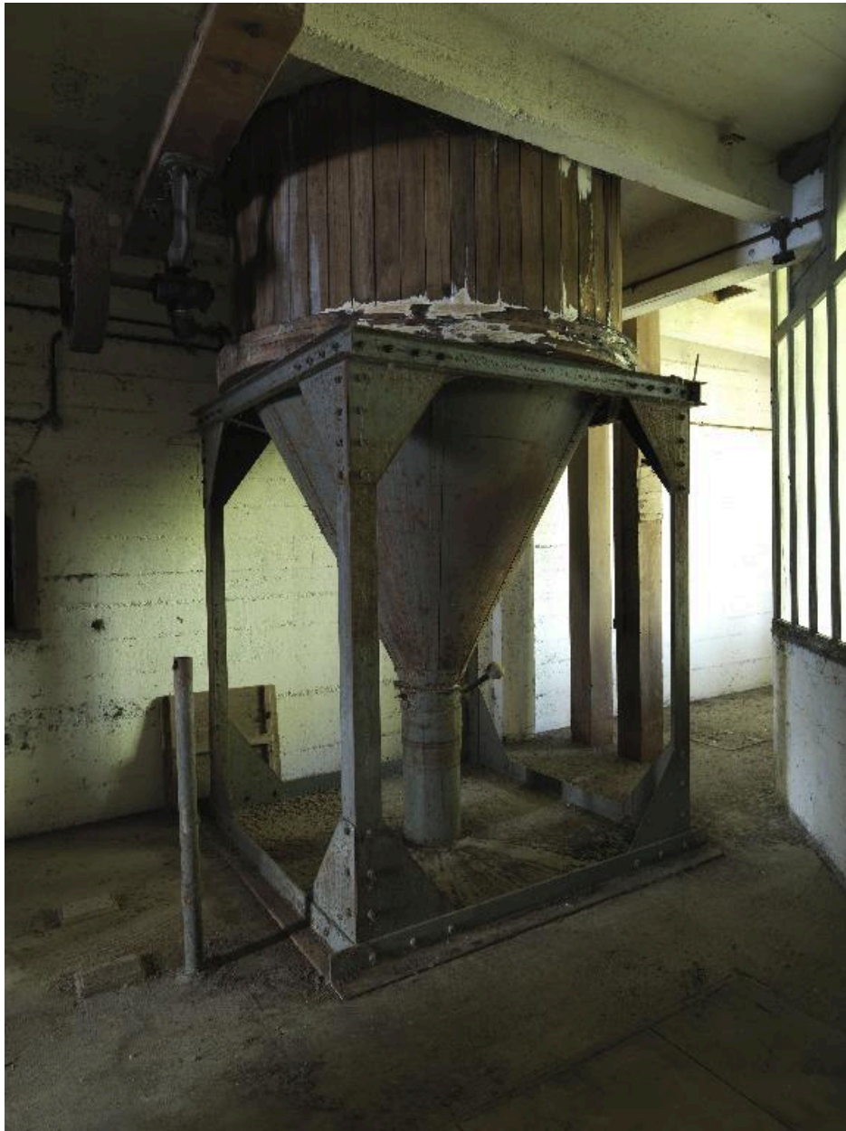
Silo et dévidoir de minoterie.
