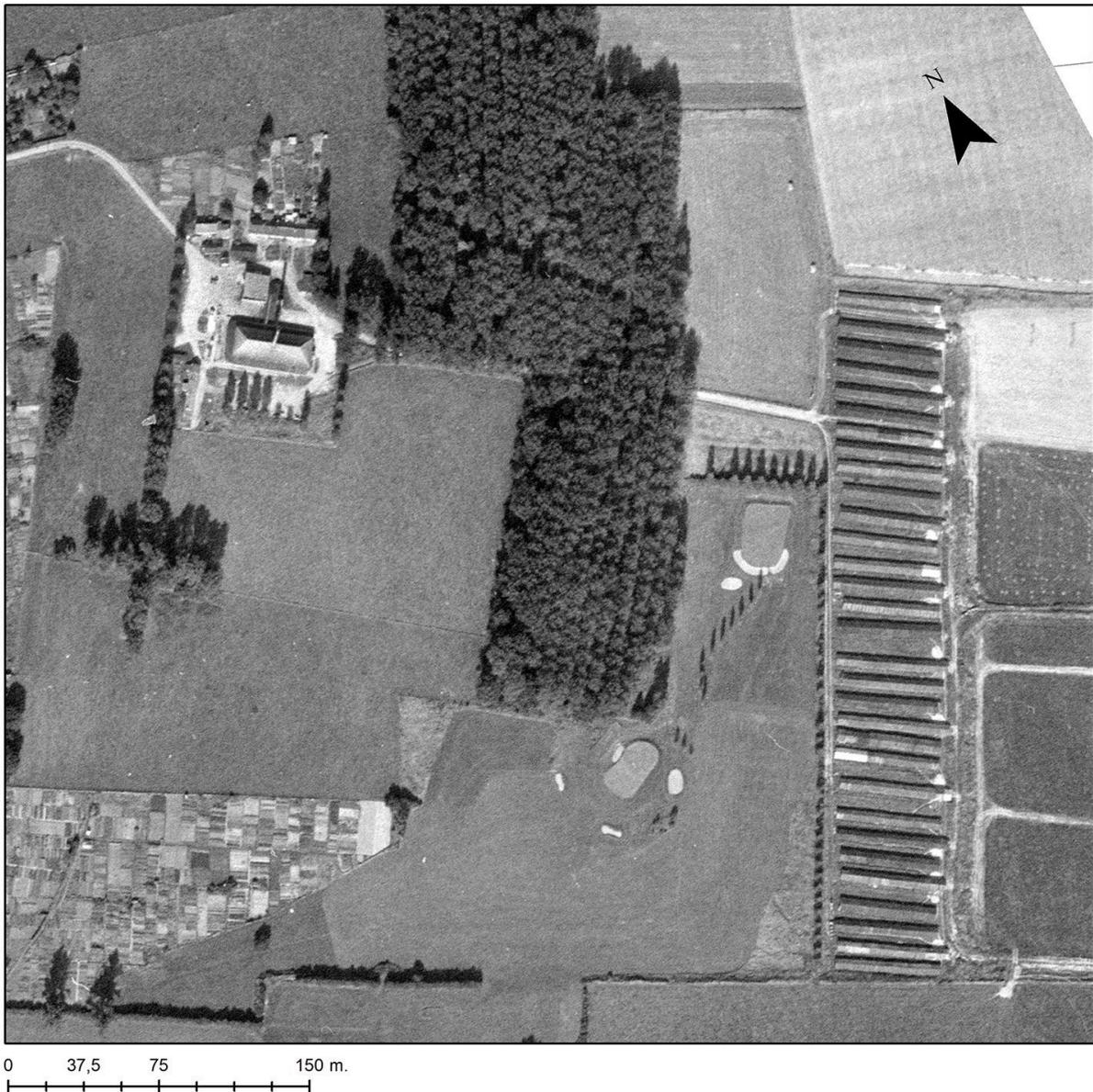
La briqueterie (en haut à gauche) et ses séchoirs (au centre) en 1969. Se distinguent, à droite, les voies étroites conduisant à la carrière d'argile (Source IGN. Photothèque nationale. 1969).
