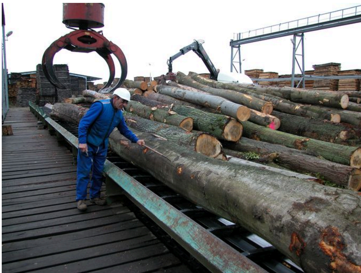
Chargement des grumes sur le tapis roulant.
