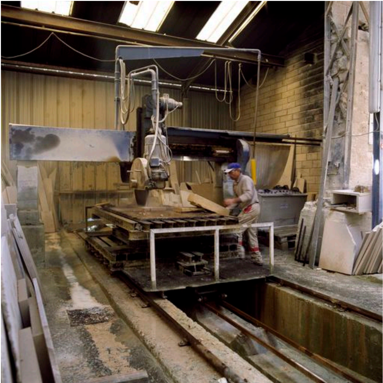
Sciage de la pierre en plaques (carrière Ouachée-Corpechot, Saint-Maximin).
