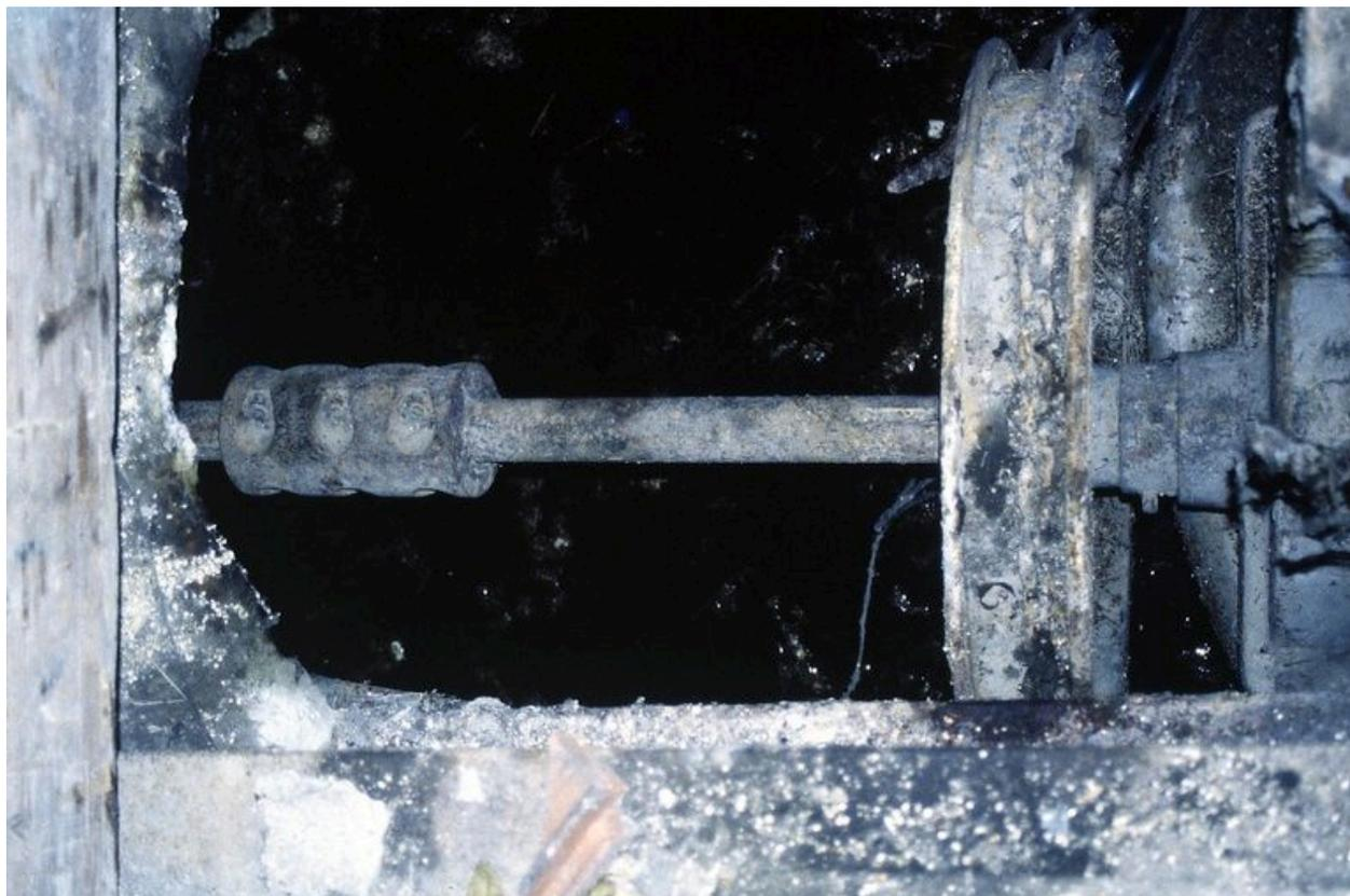
Détail de l'arbre de transmission reliant les turbines.
